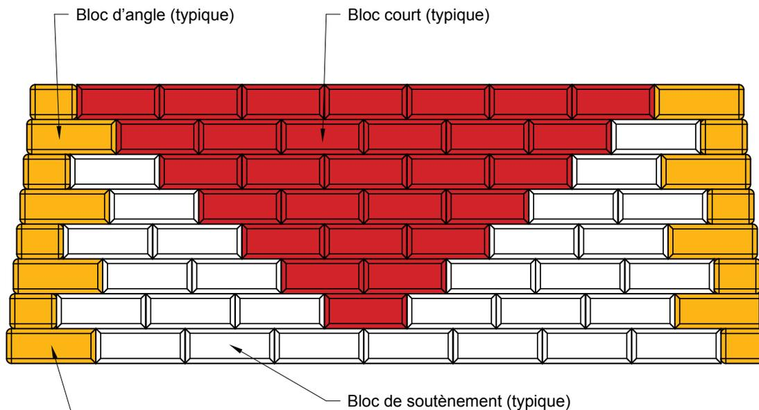
Alternance des faces longues et courtes des blocs d'angle autoporteurs à chaque extrémité des rangées pour un espacement adéquat (typique)
