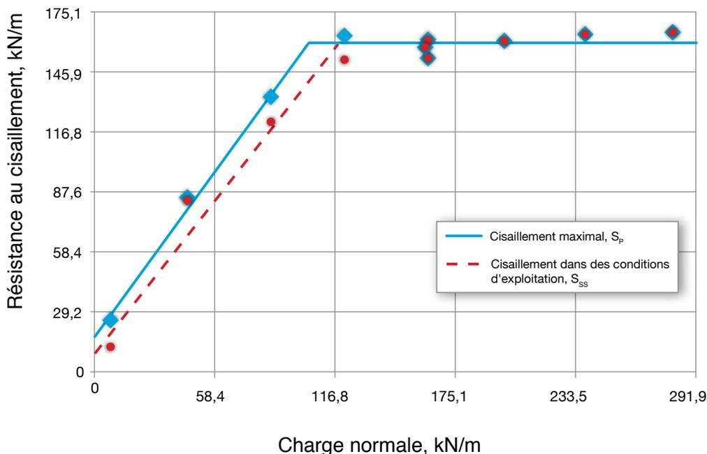
(a) La résistance à la compression à 28 jours de tous les blocs de béton testés lors de la série de tests de cisaillement d'interface de bosse de 10 pouces (254- millimètres) s'élevait à 4 474 psi.
