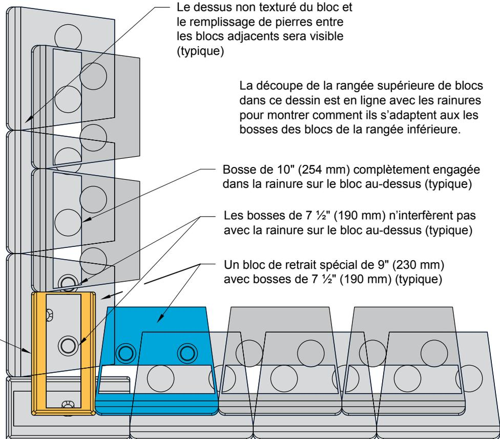
Le dessus non texturé du bloc et le remplissage de pierres entre les blocs adjacents sera visible (typique)
