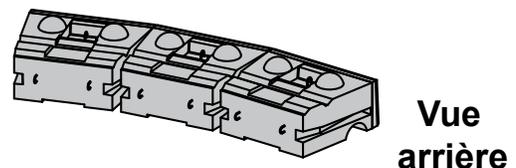
\* La distance entre les blocs est mesurée à l'arrière des blocs de 28" (710 mm) et à 24" (610 mm) derrière la ligne de séparation de forme (bord postérieur de la texture de la face visible) pour les blocs de 41" (1 030 mm). Cette distance est fournie à titre purement indicatif. Le rayon minimum détermine cette distance.
