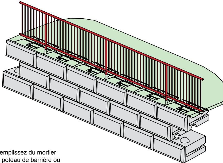
Remplissez du mortier le poteau de barrière ou de garde-corps à son emplacement
