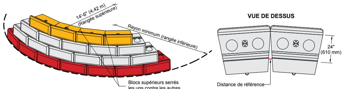
Il est possible de réaliser des courbes concaves de différents rayons. Les blocs doivent être serrés fortement les uns contre les autres pour former une courbe régulière. Bien qu'il n'existe pas de rayon minimum défini, les rayons inférieurs à 14'6" (4,42 m) entraînent l'exposition d'une plus grande surface de la face supérieure non texturée des blocs sur la couche inférieure.
