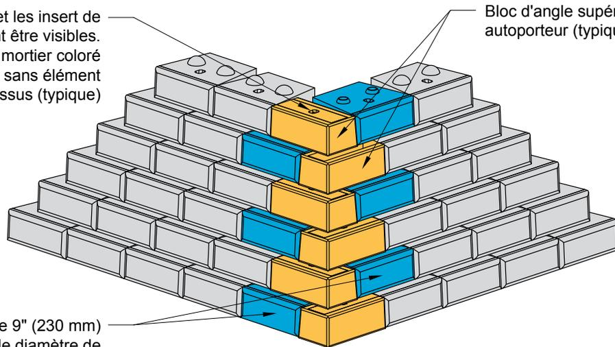
Bloc de retrait spécial de 9" (230 mm) avec bosses de diamètre de 7 1/2" (190 mm) (typique)
