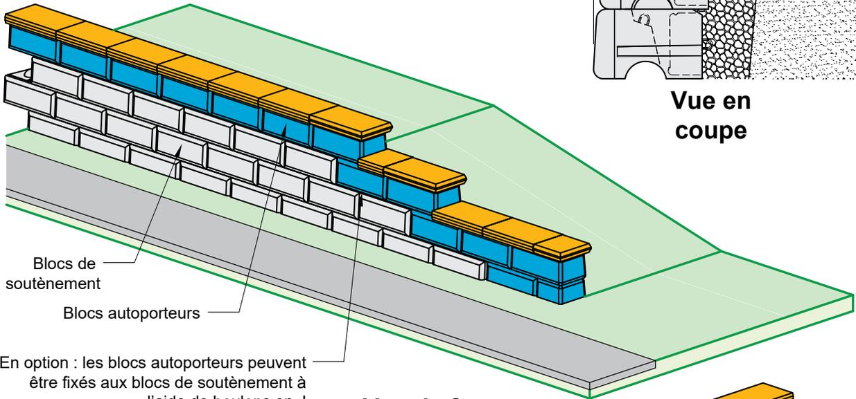
Blocs de soutènement
